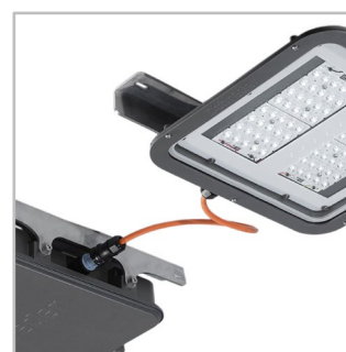
A szerszámmentes, tűzálló vezetékekkel előre szerelt TFLEX MODULE jelentősen csökkenti a telepítés idejét, javítja a minőséget, és nagyobb megbízhatóságot eredményez.
