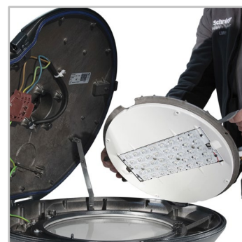
A FLEXIA POEME felnyitáskor azonnal lecsatlakozik az elektromos hálózatról, az optikai egység pedig szerszámok nélkül cserélhető.
