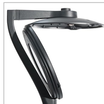
A FLEXIA FG felnyitáskor azonnal lecsatlakozik az elektromos hálózatról, az optikai egység pedig szerszámok nélkül cserélhető.
