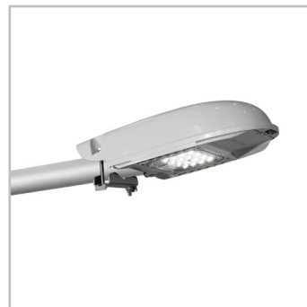
Pecíz helyszíni beállítás. A dőlésszög -15° és +5° között állítható karos rögzítés esetén, oszlopcsúcsos adapterrel pedig -10° és +10° között.
