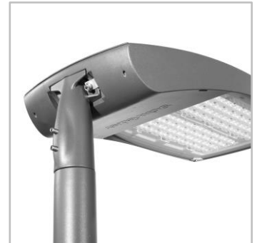
A TECEO GEN2 család univerzális rögzítési lehetőséget kínál Ø32mm- Ø76mm átmérőjű csővégekre. Speciális Ø60mm átmérőjű becsúsztható csatlakozással is rendelhető.
