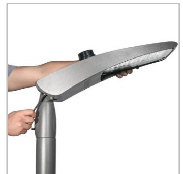
A dőlésszög a helyszínen állítható oszlopcúcsos (0-tól +15°-ig) és karos rögzítés (0-tól -15°-ig) esetén is.
