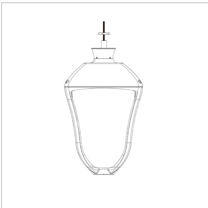
STYLAGE | Függesztett rögzítés 1" anya vagy 3/4" gas rögzítőelemmel
