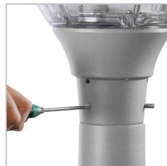
A HAPILED rácsúsztatás után rögzíthető 60mm átmérőjű oszlopcsúcsra 6 M6-os csavarral.
