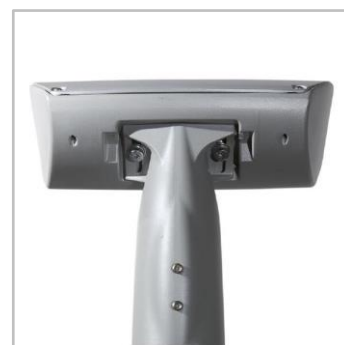
A Teceo család univerzálisan rögzíthető Ø32 - Ø76mm-es karra vagy oszlopcsúcsra
