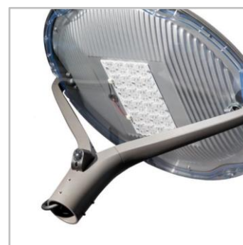
Az Oyo 60mm átmérőjű oszlopcsúcsra szerelhető kivitelben 6 db M8 csavarral egyszerűen rögzíthető
