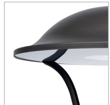
Az optikai teret síküveg zárja le, amely megakadályozza a fényszennyezést (ULOR=0%)
